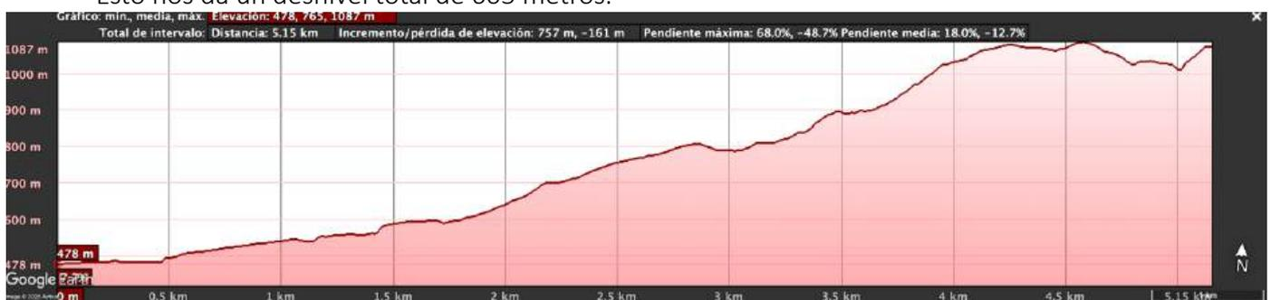
Perfil de elevaciones del trazado de la tubería. Fuente: Google Earth Pro
