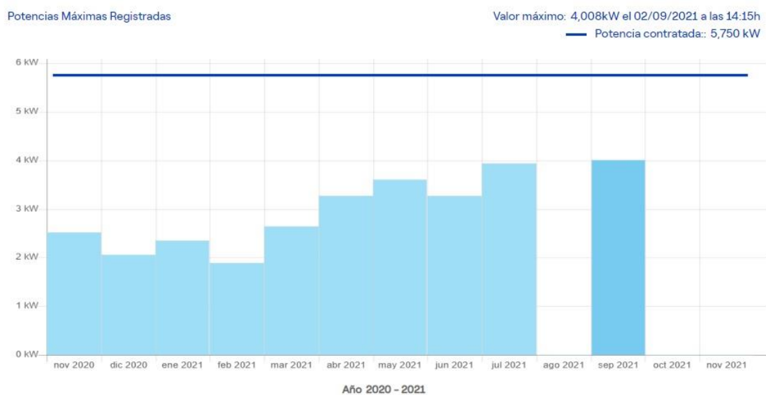
Figura 32: Potencia máxima demandada frente a potencia máxima contratada en caso de estudio nº5
