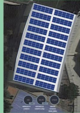
**Polideportivo de Benalúa:** instalación máxima de 162 kWp aproximadamente producida por 330 módulos diferentes. Se pueden repartir 324 box de 0,5 kWp.
