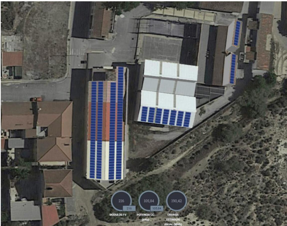
Gracias a SolarEdge Designer se puede saber con gran exactitud la potencia que produciría la instalación de las placas fotovoltaicas. Esa es la energía que se repartiría en caso de existir dicha instalación, siendo la potencia mínima por miembro de 0,5 kWp, es decir, al menos 500 vatios (lo que equivale a un panel solar). Por ello, sin tener en cuenta cuanto necesita el ayuntamiento para sus infraestructuras y servicios, se reparten 210 box de 0,5 kWp cada uno.
