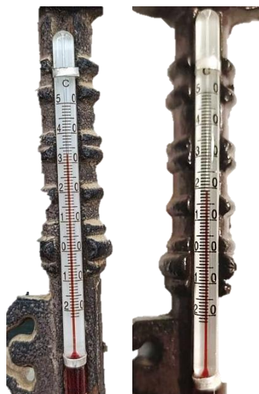
Ilustración 7. Termómetro que marca la temperatura exterior (izquierda) de casi 35 °C y la temperatura en el interior de la cueva (derecha) por debajo de los 20°C. Ambas mediciones realizadas a la misma hora en la cueva del futuro Centro Documental.
